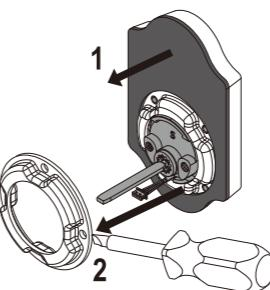
Passez cette étape si la profondeur du trou de porte est de 54 mm (2 1/8 po). Pour un trou de 38 mm (1 1/2 po) : 1 Retirez la plaque arrière en caoutchouc noir de l'assemblage extérieur. 2 Effectuez un effet de levier sur collier adaptateur avec un tournevis. Réinstallez la plaque arrière et continuez.
