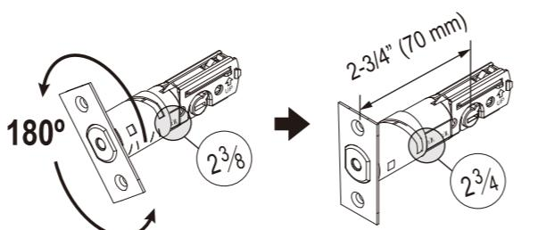
Cb Si el borde de la puerta no tiene una muesca cortada, ajuste el perno como se muestra.
